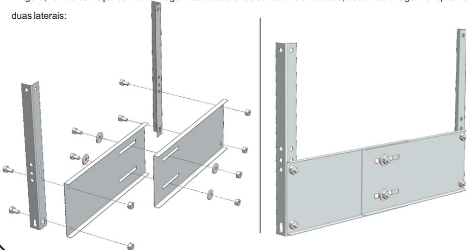
Na fixação das travessas nas cantoneiras, utiliza-se apenas o parafuso e a porca. Na montagem das duas travessas (uma dentro da outra) utiliza-se a porca, o parafuso e a arruela, como mostra a imagem anterior.
