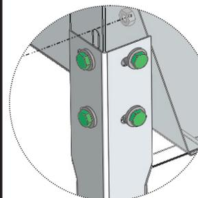
Fixação dos parafusos, porcas e arruelas dos pés na estrutura.
