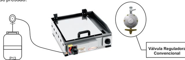
2º Quando os botijões estão distantes, em uma central, instala-se no local a primeira válvula, de 1º estágio (manômetro), colocando como condutor do gás até o produto uma tubulação de cobre. Instale no final, ao lado do fogão, uma válvula reguladora de gás.
