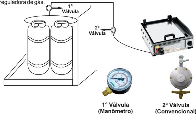
Certifique-se de que não há vazamento nas válvulas e nas ligações das mangueiras. Para isso, utilize sabão ou detergente, se formar bolhas é sinal de que há vazamento. **NUNCA UTILIZE FOGO.**
