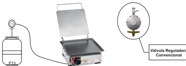
2º Quando os botijões estão distantes, em uma central, instala-se no local a primeira válvula, de 1º estágio (manômetro), colocando como condutor do gás até o produto uma tubulação de cobre. Instale no final, ao lado do fogão, uma válvula reguladora de gás.
