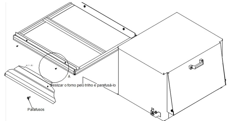
**Instalação do Forno no Fogão**
