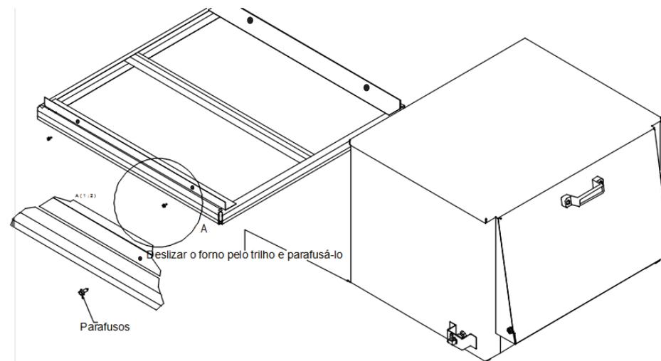
**Instalação do Forno no Fogão**
