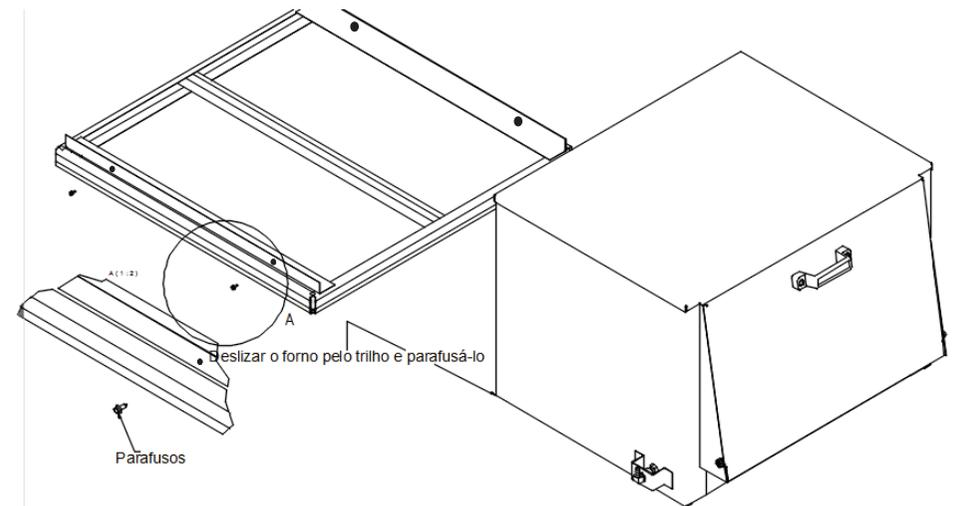
**Instalação do Forno no Fogão**
