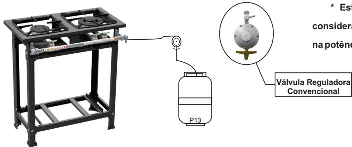
2º Quando os botijões estão distantes do fogão, em uma central, estala-se no local a primeira válvula, de 1º estágio (manômetro), colocando como condutor do gás até o fogão uma tubulação de cobre. Instale no final, ao lado do fogão, uma válvula reguladora de pressão.
