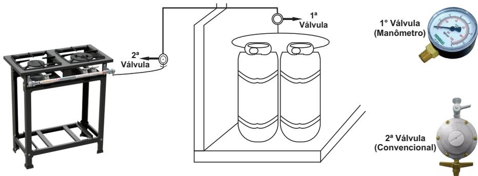
Certifique-se de que não há vazamento nas válvulas e nas ligações das mangueiras. Para isso, utilize sabão ou detergente, se formar bolhas é sinal de que há vazamento. **NUNCA UTILIZE FOGO.**
