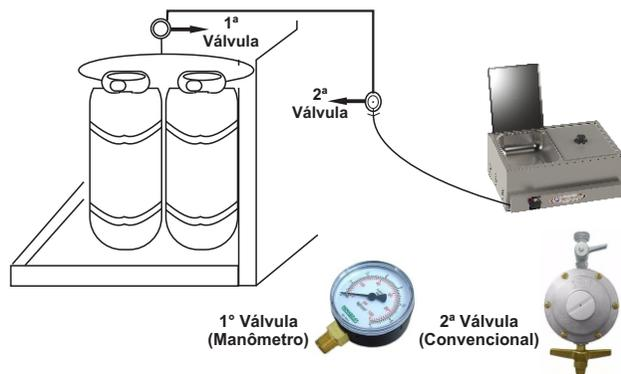
Certifique-se de que não há vazamento nas válvulas e nas ligações das mangueiras. Para isso, utilize sabão ou detergente, se formar bolhas é sinal de que há vazamento. **NUNCA UTILIZE FOGO.**
