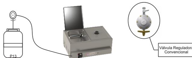
2º Quando os botijões estão distantes, em uma central, estala-se no local a primeira válvula, de 1º estágio com entrada de 7 Kg/cm<sup>2</sup> e pressão de saída de 1,2 Kg/cm<sup>2</sup>, colocando como condutor do gás até o produto uma tubulação de cobre. Instale no final, ao lado do fogão, uma válvula com entrada de 1,2 Kg/cm<sup>2</sup> e saída de 2,8 kPa (kilopascal).
